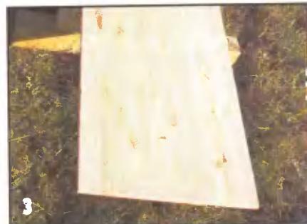
Мебельный щит больших размеров (2500х600 мм) тоже из сосны. Сучков на нём — побольше.
