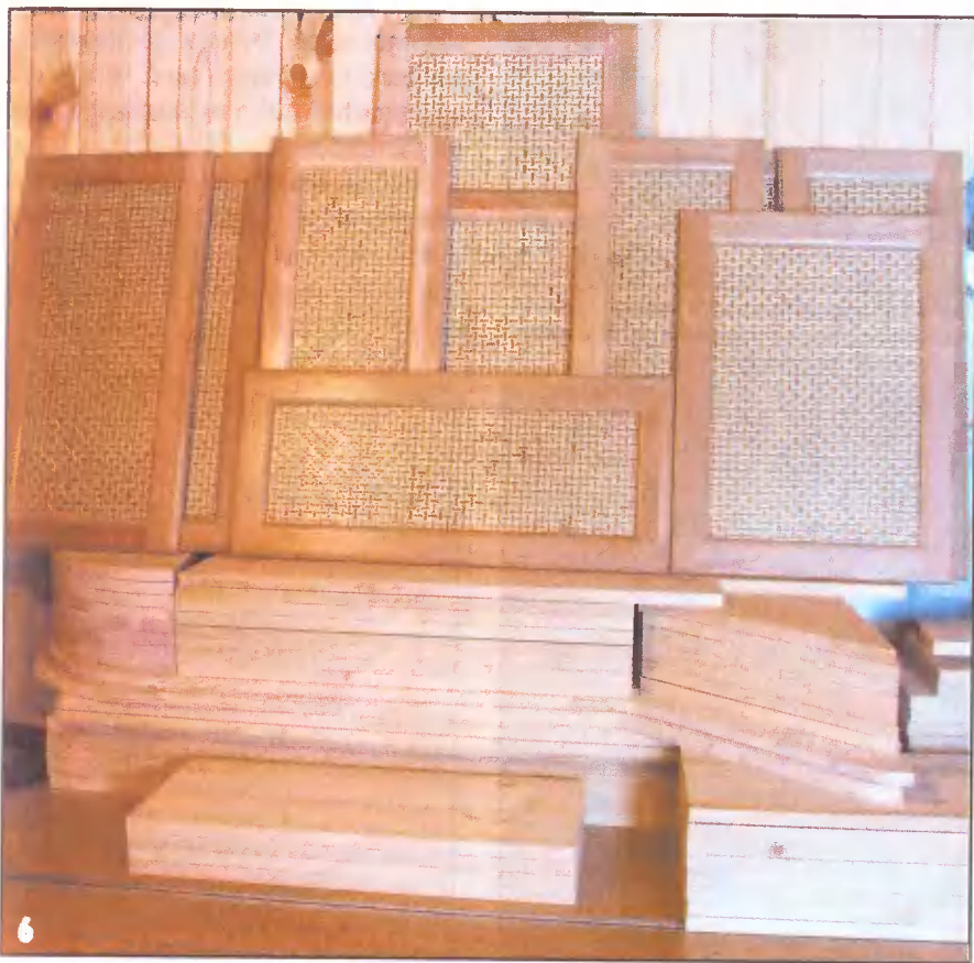
Дверки, в которых рамка выполнена из бука, а вставка — из бамбуковой плиты, наклеенной на основу из фанеры.
