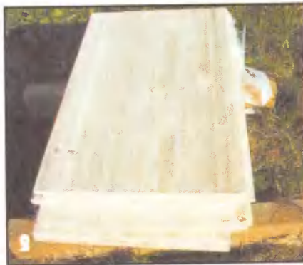
Мебельный щит небольших размеров (1000х600 мм) из сосны. Видно, что сучков немного.
