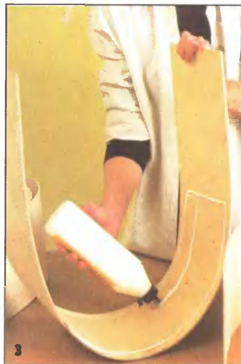
Направления волокон древесины наружных слоев у прямых и гнутых заготовок – разные. У прямых – вдоль заготовок, а у гнутых – поперек.
